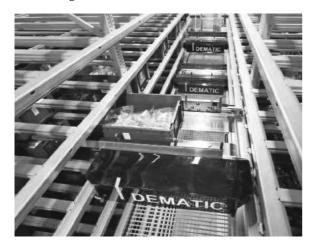
Effizient: Mittels Synchronmotoren werden die Energiekosten des FlexSort SC3 um bis zu 50 % gesenkt. (Foto: Dematic)
