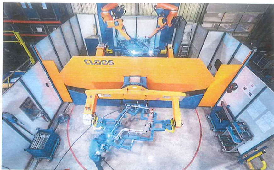
▲ Einsatz von Schweißrobotern für Unterbaugruppen von Kabinen, wie z. B. Seitenrahmen.
