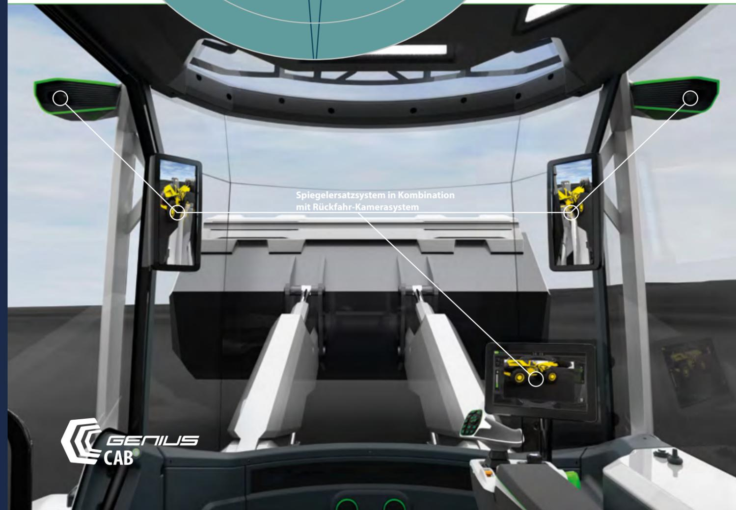
Spiegelersatzsystem in Kombination mit Rückfahr-Kamerasystem
